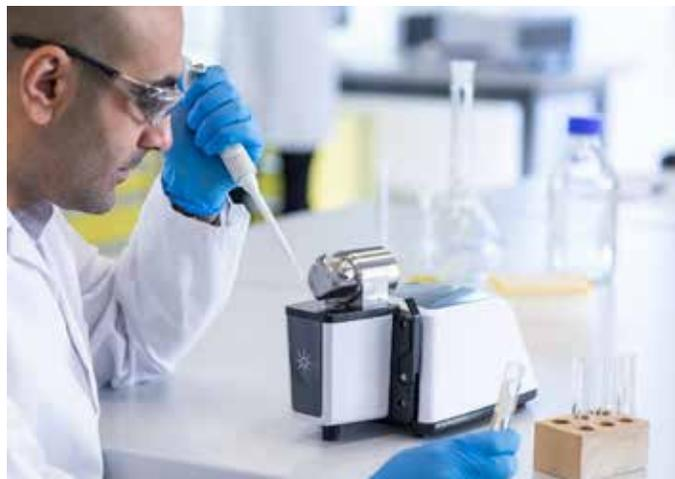
**Рисунок 2.** Жидкая проба помещалась на окошко для пробы модуля DialPath, подключенного к ИК-Фурье-спектрометру Agilent Cary 630.
