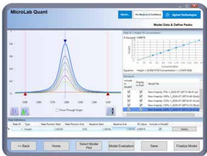
**Рисунок 5.** Оценка линейности для модуля DialPath с помощью ПО MicroLab Quant. Калибровочные кривые строятся и коэффициенты корреляции рассчитываются программой автоматически. Пользователи могут вывести полученные результаты в отчет для документирования.
